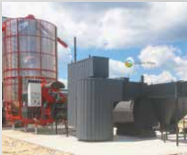
Зерносушарка Pedrotti Large 270 та теплогенератор ТПК 15
